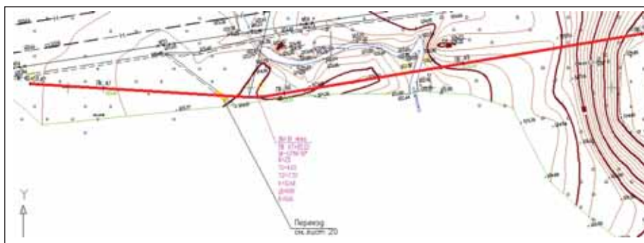
Рис. 13. Создание плана трассы трубопровода
